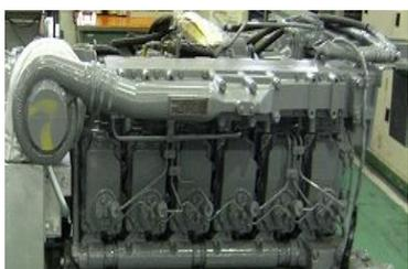
・全般検査(最長8年)ごとに車両のエンジン取替
