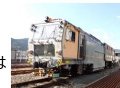
保守用車両による道床の突き固め
