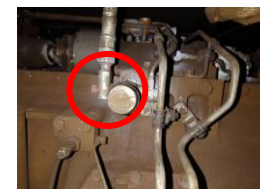
燃料フィルター設置箇所（車両床下）
