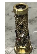
ゴミつまり箇所（フィルター内部）
