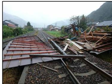
※台風 21 号の風によって線路脇の作業小屋が倒壊し線路を支障
