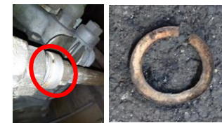
破損箇所（パッキンの破れ）
