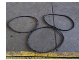
充電発電機ベルトの損傷
