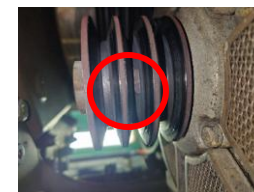
ベルトを回転させる箇所に打痕傷
