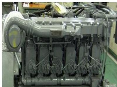
・全般検査 (最長 8 年) ごとに特急車両のエンジン取替
