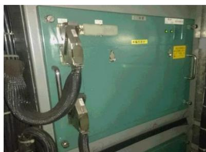
・曲線に併せて車体を傾斜させる装置
