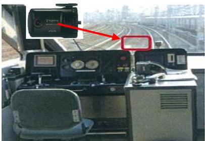
・運転室に前方の映像を記録する録画装置と運転室内の音声を録音する装置
